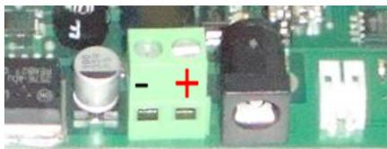
In alternativa al jack di alimentazione, è possibile utilizzare il morsetto a due poli, rispettando la polarità mostrata in figura.
