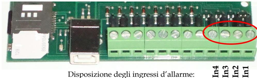
Gli ingressi sono polarizzati normalmente allo stato logico alto, grazie ad un pull-up interno al microcontrollore, che li pone alla tensione +Vcc micro, pari a circa 3,3V.
